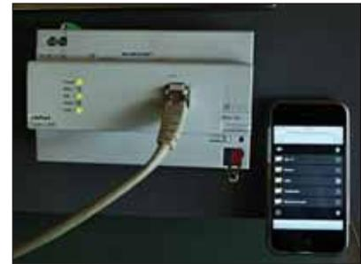
eibPort dient nicht nur als Schnittstelle zwischen EIB und Ethernet – es ermöglicht auch die unkomplizierte Erstellung einer leistungsfähigen Visualisierung für PC, Display, Palm oder iPhone.
